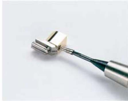
Abb. 2 Befestigen Sie anstelle der original Patrizenaufnahmekappe das Klebehilfsteil Nr. 890 mit der Kombischraube Nr. 886 an der Patrize.
