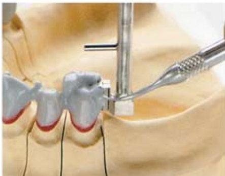
Abb. 3 Wachsen Sie die Matrize an die Kronen. Achten Sie darauf, daß die Seitenflächen der Matrize mit einer min. 0,5 mm starken Wachsschicht bedeckt ist.
