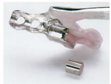
Abb. 9 Wachsen Sie die Innenseite der Gewindekappe und den Schubverteilungs-arm aus (Schutz beim Sandstrahlen).
