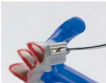
Abb. 6 Wachsantefter dürfen unter keinen Umständen auf die Geschiebeflächen aufgetragen werden, da die Gefahr besteht, daß während des Gußprozesses Metall auf diese Flächen fließt. Um ein einwandfreies Einfließen der Einbettmasse sicherzustellen, bringen Sie in die Matrize einen kleinen Wassertropfen ein.
