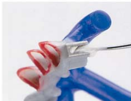
Abb. 7 Nach Anrühren der erforderlichen Einbettmasse (Muffelgröße) halten Sie den Gummiteller vertikal auf den Rüttler und lassen die Einbettmasse mit einer Sonde in die Matrize einfließen. Setzen Sie den Muffelring auf und betten Sie ein wie gewohnt.
