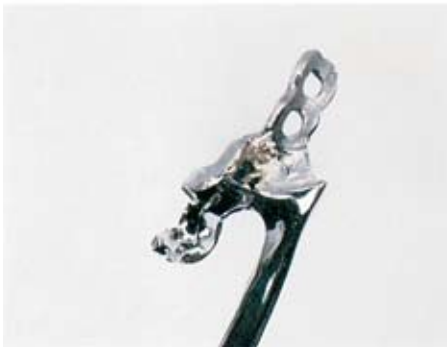
Abb. 7 Löten Sie wie gewohnt. Eventuell entstandene Oxyde im Inneren der Patrizenaufnahmeplatte werden nur durch Absäuern entfernt (Paßgenauigkeit), also nicht abstrahlen!
