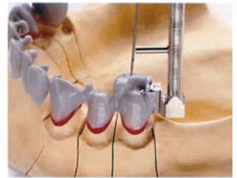
Abb. 2 Der Horizontalstift des Parallelhalters kennzeichnet die Auszugslänge der Patrize. Markieren Sie diese auf Ihrer Wachsmodellation. Die Interlockfräsung muß immer mesial von dieser Markierung angebracht werden. Korrigieren Sie ggf. die Position der Matrize, da sonst ein Austauschen der Patrize nicht möglich ist.
