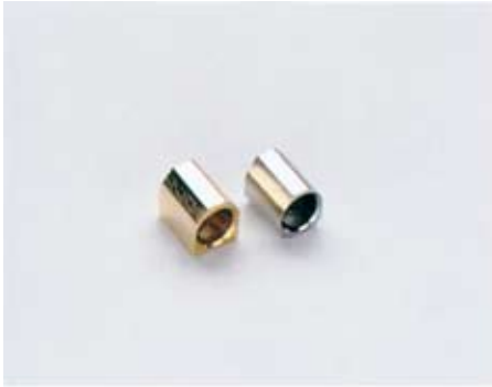
Abb. 1 Das Klebehilfsteil Nr. 890 hat im Gegensatz zur original Patrizenaufnahmekappe Nr. 884 ein Aufmaß von 0,1 mm, um eine definierte Kleb- oder Lötspaltstärke zu gewährleisten.
