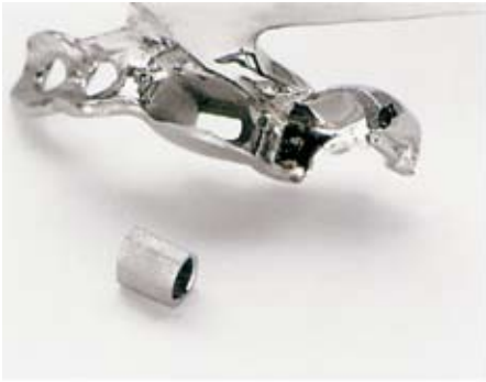
Abb. 10 Strahlen Sie die Kappe und die Kappenaufnahme in der Modellgußbasis mit 250 µm Korund bei ca. 5 bar Druck ab. Entfernen Sie das Ausblockwachs mit Dampfstrahlen.
