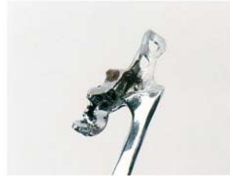
Abb. 6 Kontrollieren Sie, daß kein Flußmittel in die frontale und basale Bohrung der Patrizenaufnahmeplatte geflossen ist.
